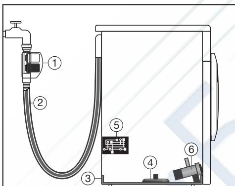
① Два магнитных клапана
